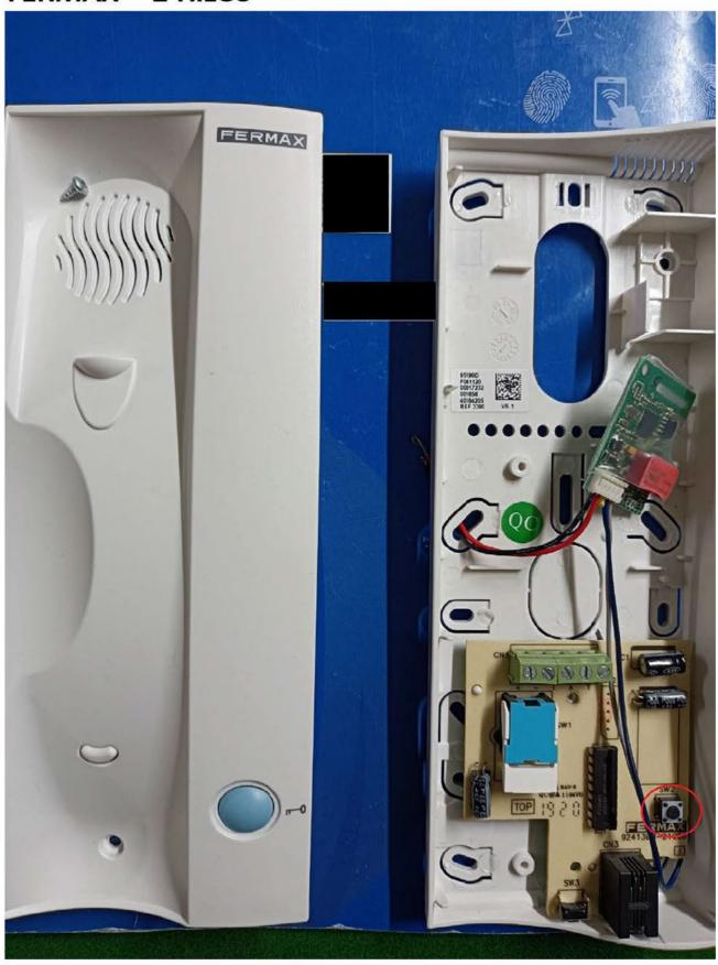
Botón de apertura frontal, quitamos tornillo sujeción placa electrónica y soldamos en la trasera.
